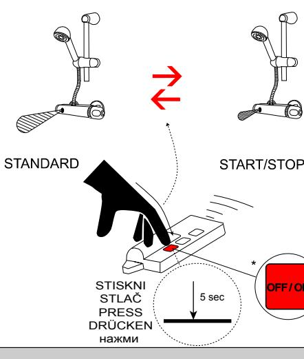
**Instalace, Inštalácia, Instalacja, Installation, Схема включения и монтажа, Montavimo ir įjungimo schema, Instalare**
