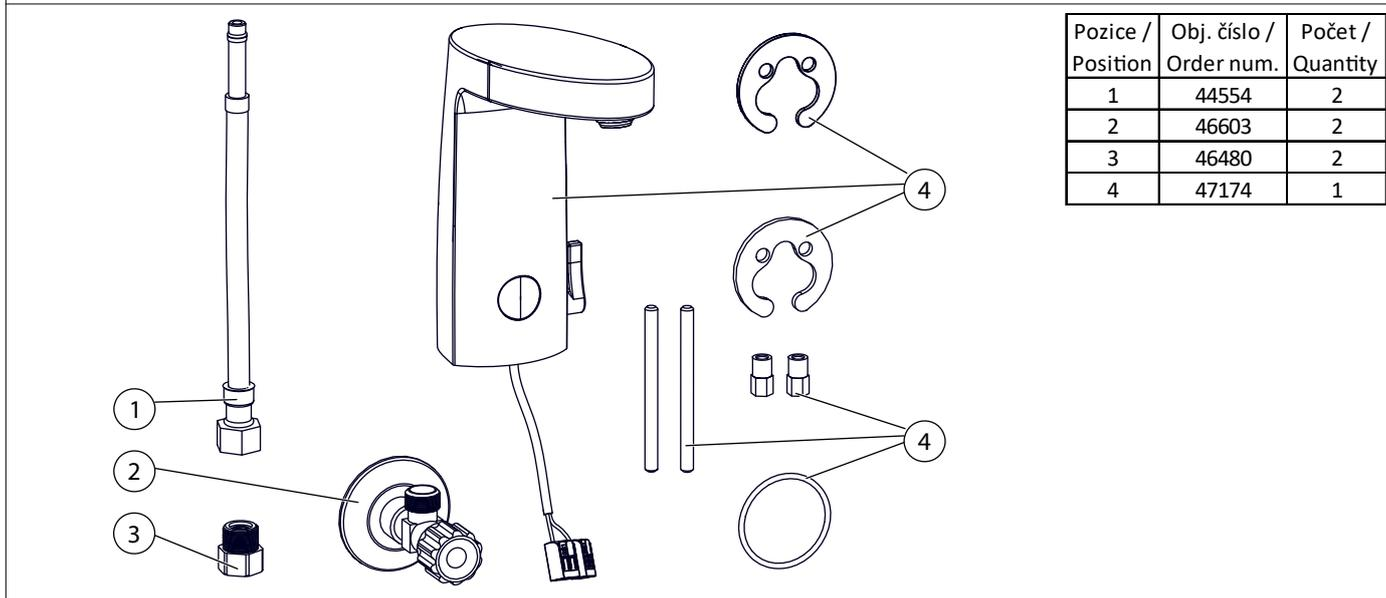
(CZ) Instalace (RU) Схема включения и монтажа (RO) Instalare (NL) Installatie
